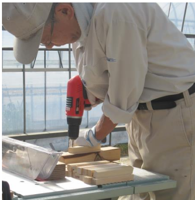
仕上げはドリルで穴開け
